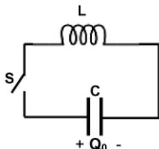
A partir del instante en que se cierra el interruptor, ¿cuál de los siguientes gráficos representa la forma en que varía la carga  $Q$  en el condensador, a medida que transcurre el tiempo  $t$ ?
